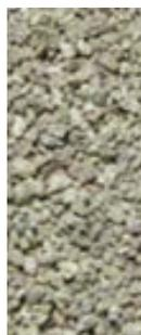
Composé d'attapulgite calcinés à haute température.
